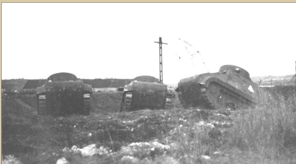
Tres carros de combate Trubia Naval durante el período de pruebas en la Constructora Naval de Sestao. Obsérvese que ninguno de los carros lleva aún el armamento. Foto: Archivo Sancho de Beurko. Irargi. Gobierno Vasco
