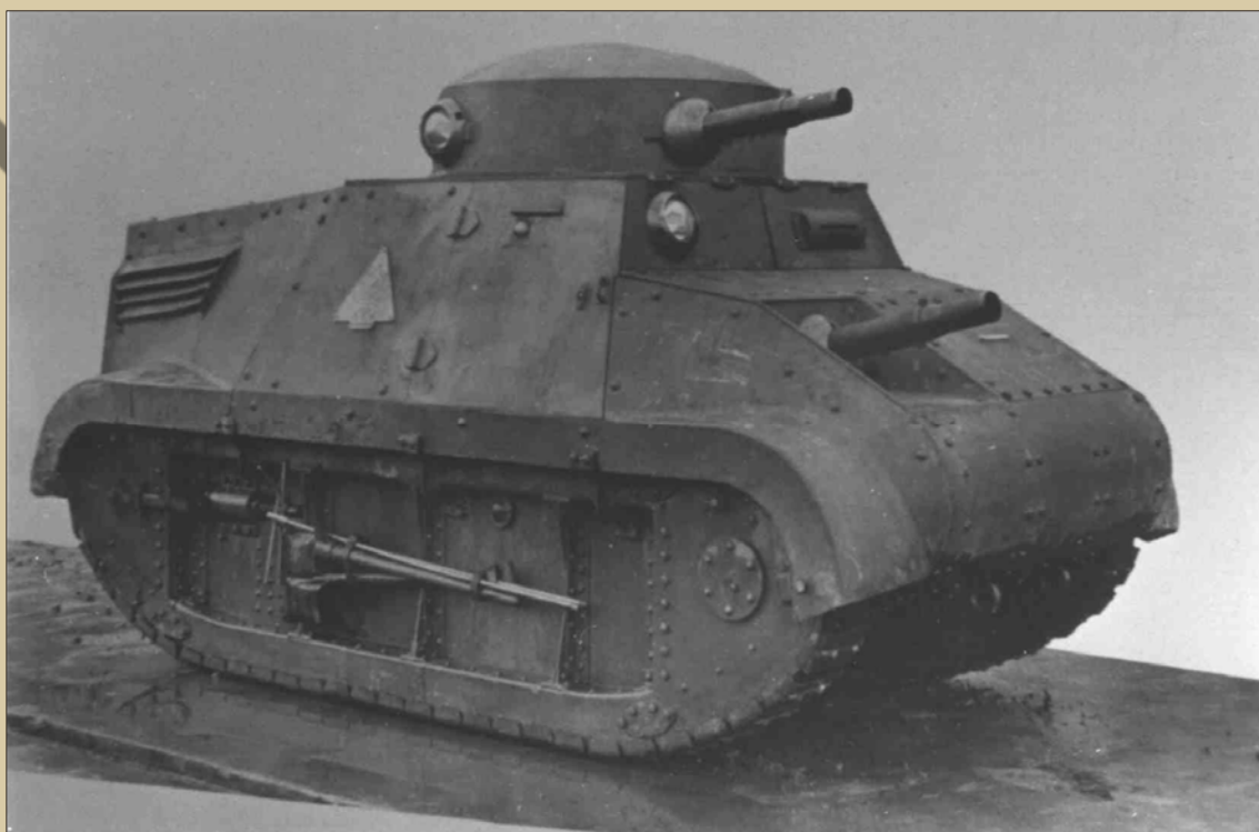
Vista del, probablemente, primer ejemplar del carro de combate Trubia Naval salido de la Constructora Naval de Sestao. En la fotografía se observa que originalmente estaba armado con dos ametralladoras Lewis, una de las cuales fue sustituida por una Degtyarev DT en las unidades de serie. Foto: Astilleros Españoles S.A.
